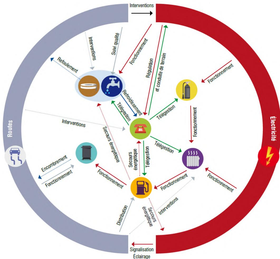
Schéma d'interdépendance entre réseaux : en pointillé les interactions spécifiques aux situations d'inondation [source : Guide Orsec Retap'Réseaux]
