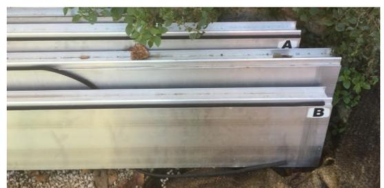
Entreposage sans protection de batardeaux provoquant une détérioration des joints
