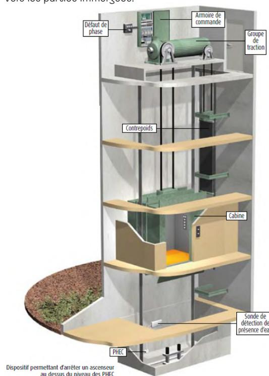
Dispositif permettant d'arrêter un ascenseur au dessus du niveau des PHEC
